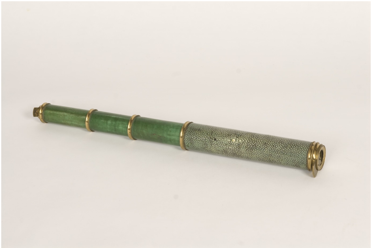
11.2 | Verrekijker met drie trekbuizen bekleed met groen perkament, hoofdbuis bekleed met groen gekleurd roggenhuid, gesigneerd 'Benjamin Martin'. totale lengte (uitgetrokken) ca. 43 cm. Londen, 3e kwart 18e eeuw. [Louwman Collection of Historic Telescopes]
